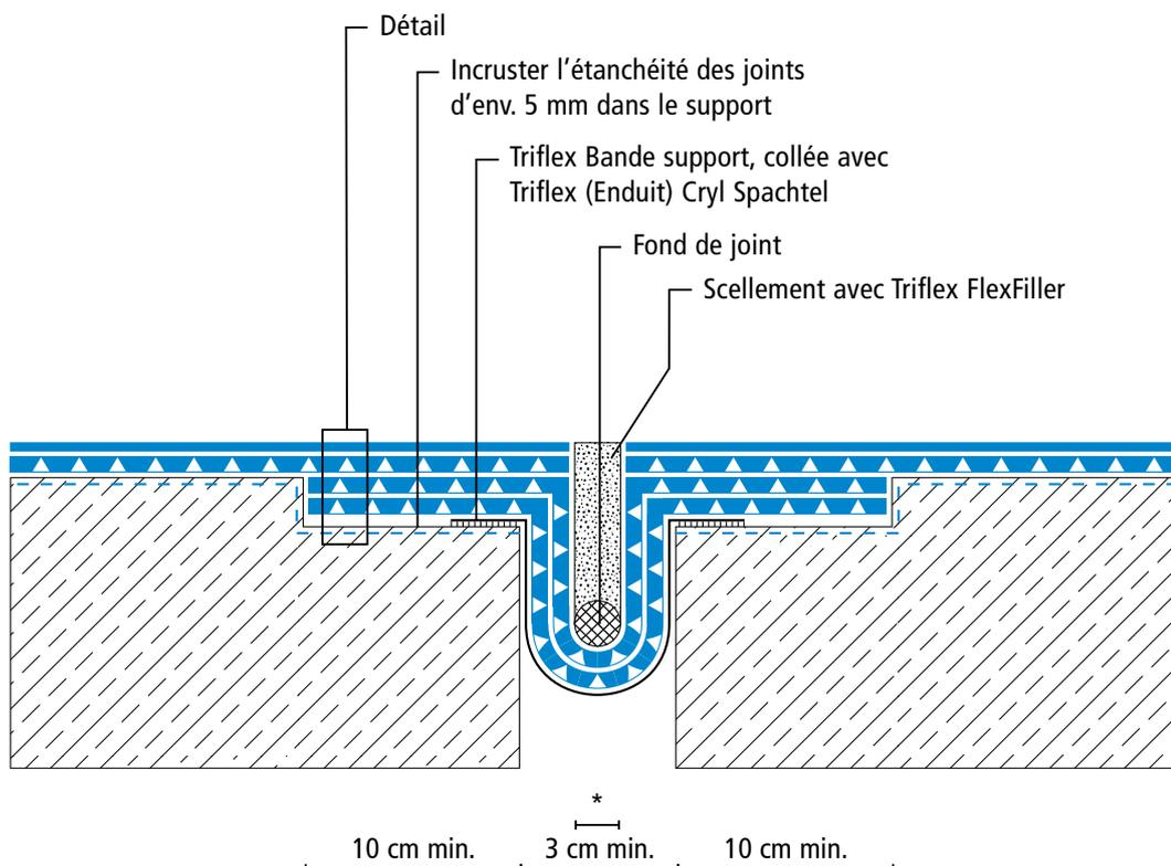
\* Emplacement pour étanchéité de surface et couche utile (voir description du système)
