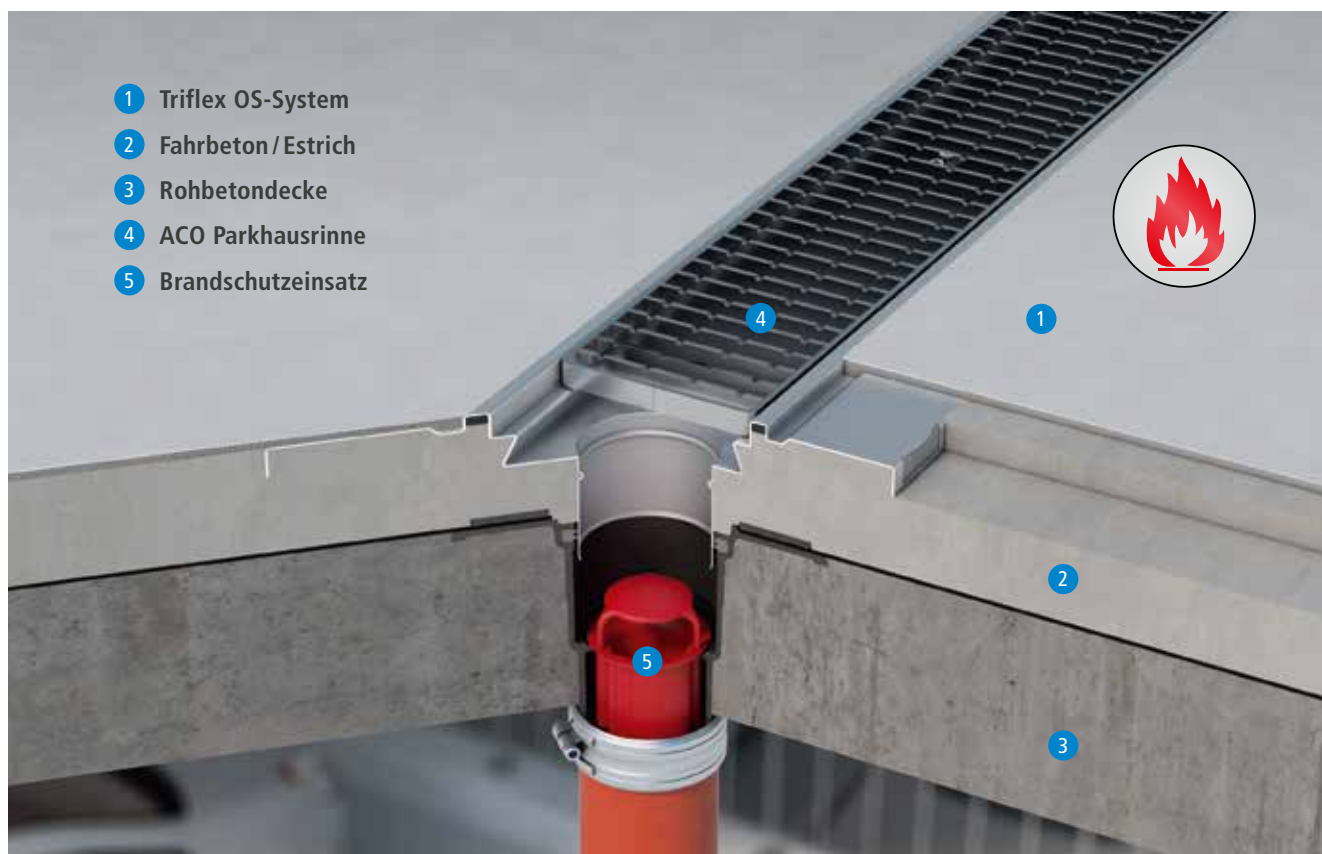
ACO Parkhausrinne mit Edelstahlrost und Anschluss an Ablaufkörper aus Gusseisen
