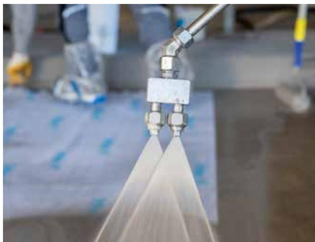
Die Düsenteknik besteht aus einer Doppel- und einer Einfachdüse, welche sich einfach austauschen lassen. Zusätzlich liegen Ersatzdüsen sowie eine Düsenverlängerung bereit. Damit die Düsen nach dem Einsatz von Triflex SAM nicht durch ausgehärtetes Material verstopfen, werden sie in einen beiliegenden Behälter mit Triflex Reiniger gelegt.
