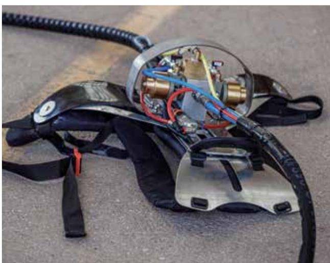
Außerhalb der mobilen Einheit werden das Mischelement sowie die Spritzpistole inklusive der jeweiligen Düse verwendet. Die Mischeinheit ist über einen Schlauch mit der mobilen Einheit verbunden. Der Schlauch beinhaltet fünf Zuleitungen, um folgende Elemente von der Maschine zur Mischeinheit zu befördern:
