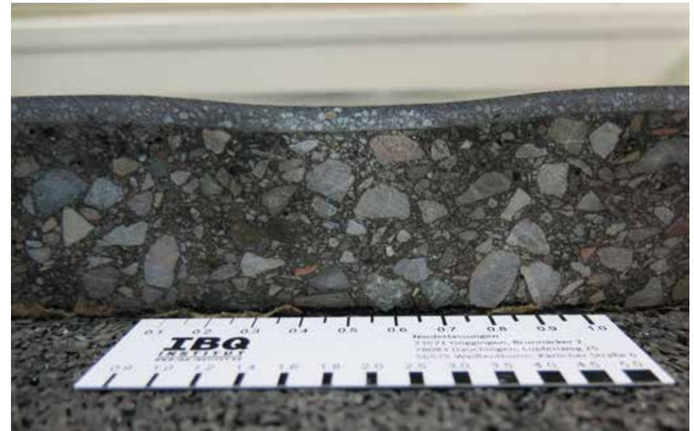
Bei Triflex Asphalt **Repro 3K** im Mischungsverhältnis 1:3 lag die Rinnentiefe dagegen unter denselben Testbedingungen bei nur 1,9 mm. Dabei betrug die aufgetragene Schichtdicke lediglich 5 mm.
