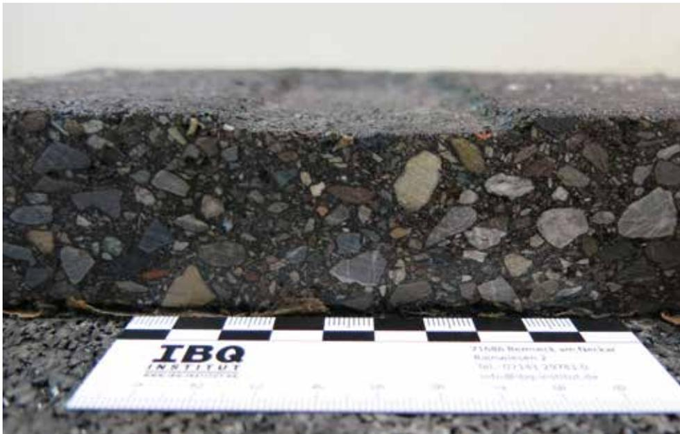
Der komplett aus dem hochwertigen Asphaltbeton **AC11 DS** bestehende Vergleichsprüfkörper wies nach dem Spurbildungstest eine Rinnentiefe von 2,2 mm auf. Gemäß Prüfvorschriften wären bis zu 8 mm Verformung noch akzeptabel gewesen.
