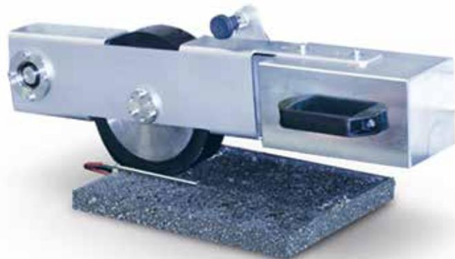
fälligkeit für Spurbildung. Bei dem Test wurden die technischen Prüfvorschriften für Asphalt (TP Asphalt-StB) zugrunde gelegt. Bei einer Prüftemperatur von 60 °C, einer definierten Radlast und 10.000 Radzyklen bestand Triflex Asphalt Repro 3K
