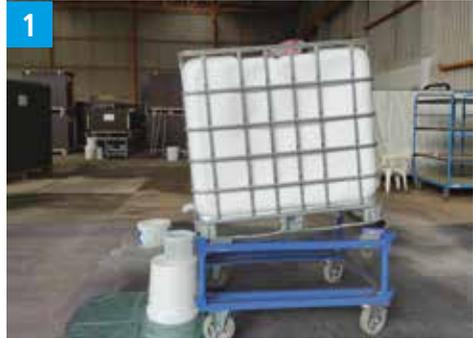
Restmaterial mit geeignetem Gummischieber zum Auslaufventil schieben.
