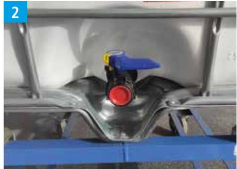
Bei Erstentnahme die versiegelte Aluplatine vom Auslaufventil entfernen.
