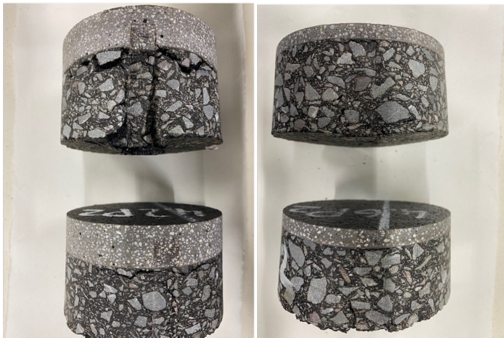
Abbildung 4.2: Links: Rissbildung im Referenzasphalt bei der 20 mm dicken Beschichtung mit Repro 3K, Rechts: minimale Rissbildung bei 5 mm dicken Beschichtung mit Repro 3K
