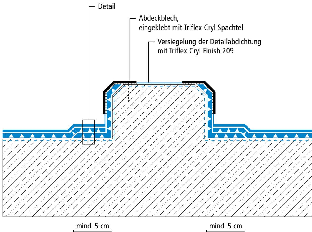
\* Waagerechte Detailabdichtungen (z. B. Arbeitsfugen) können mit Triflex ProDetail oder Triflex ProPark ausgeführt werden. Höhenversätze bei Vliesüberlappungen sind überzeichnet dargestellt.
