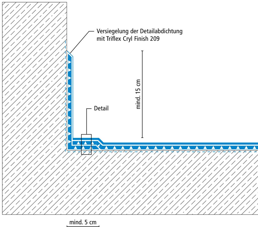
\* Waagerechte Detailabdichtungen (z. B. Arbeitsfugen) können mit Triflex ProDetail oder Triflex ProPark ausgeführt werden. Höhenversätze bei Vliesüberlappungen sind überzeichnet dargestellt.
