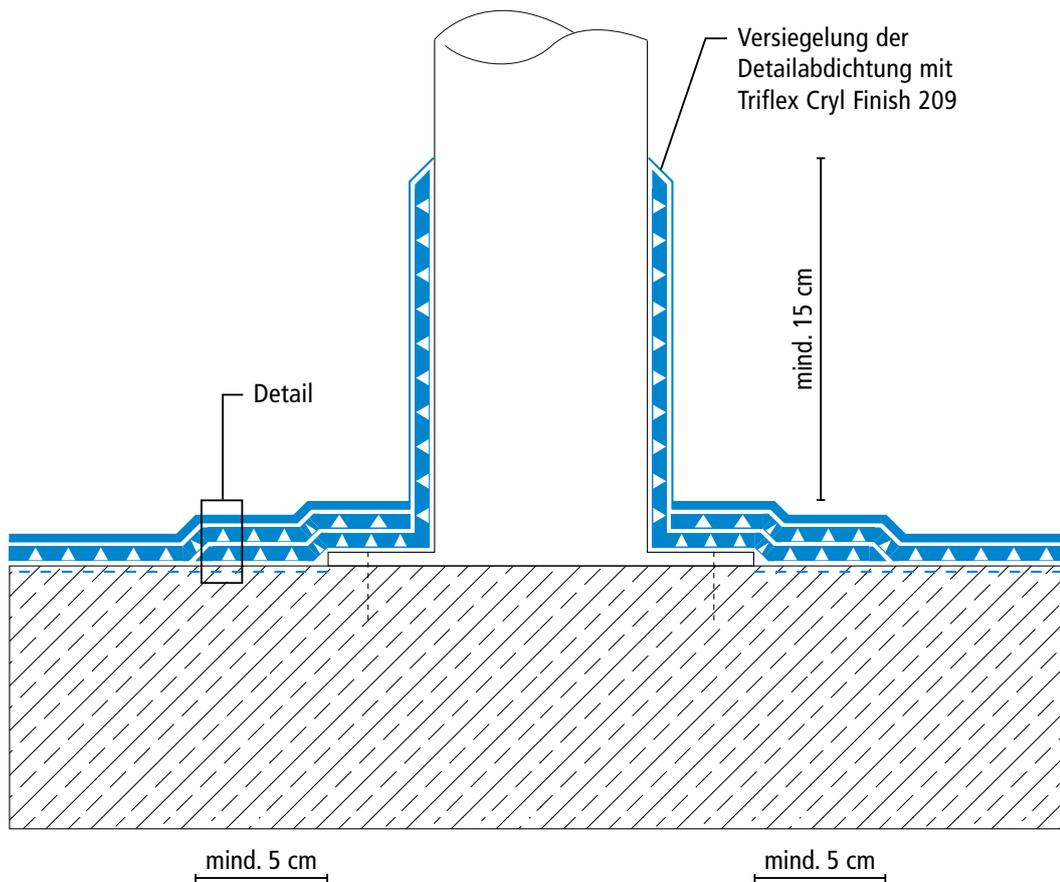
\* Waagerechte Detailabdichtungen (z. B. Arbeitsfugen) können mit Triflex ProDetail oder Triflex ProPark ausgeführt werden. Höhenversätze bei Vliesüberlappungen sind überzeichnet dargestellt.
