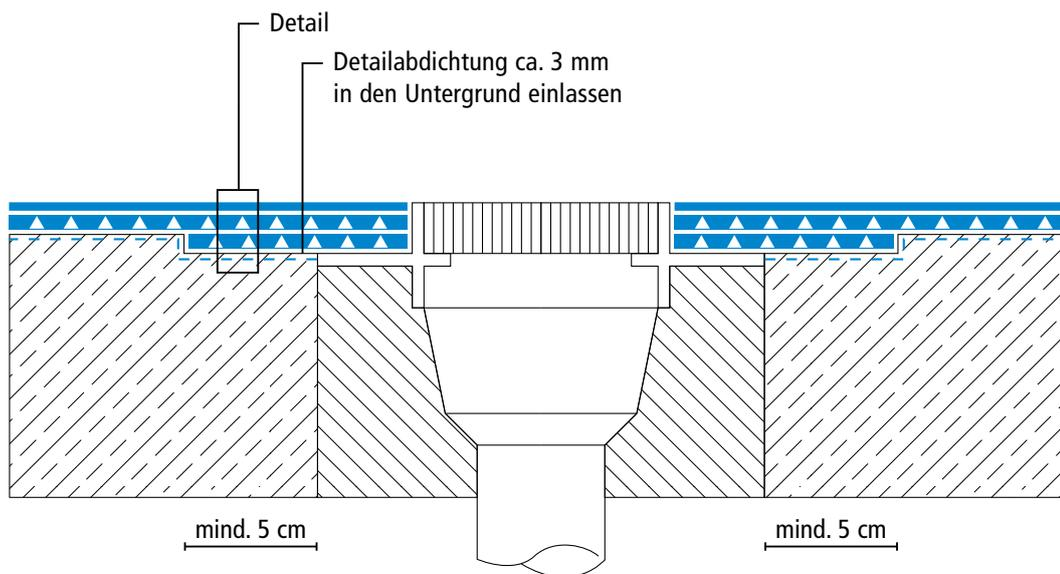
\* Waagerechte Detailabdichtungen (z. B. Arbeitsfugen) können mit Triflex ProDetail oder Triflex ProPark ausgeführt werden. Höhenversätze bei Vliesüberlappungen sind überzeichnet dargestellt.
