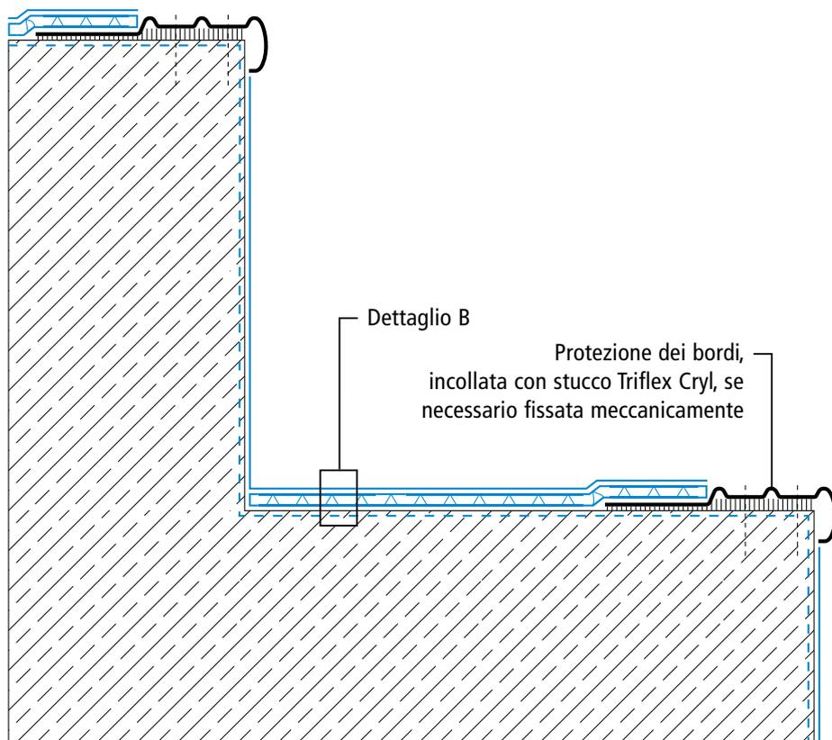
Sistema d'impermeabilizzazione per giunti in calcestruzzo impermeabile
