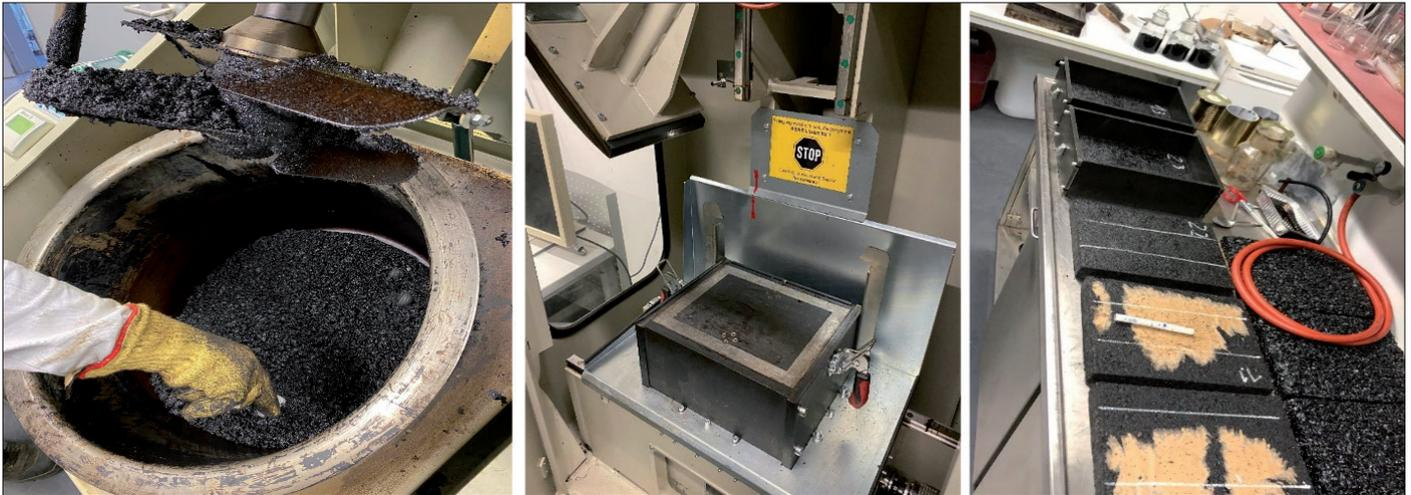
Abbildung 3.1.1: Herstellung der Probeplatten, links: Mischgutherstellung, Mitte: Walzsektor-Verdichtungsgerät, rechts: Probeplatten
