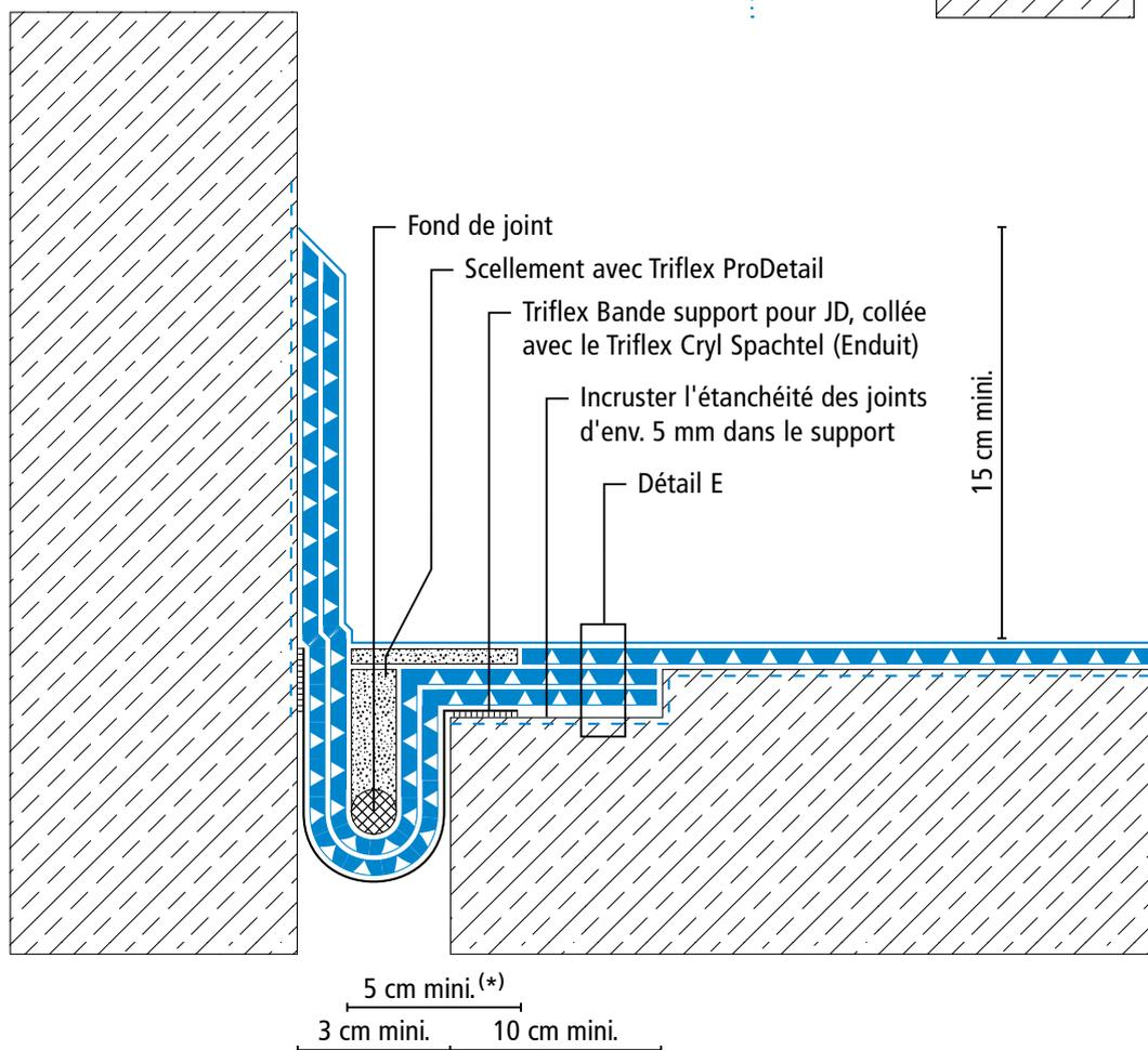
(\*) Emplacement pour système d'étanchéité de surface et couche utile (voir description du système)
