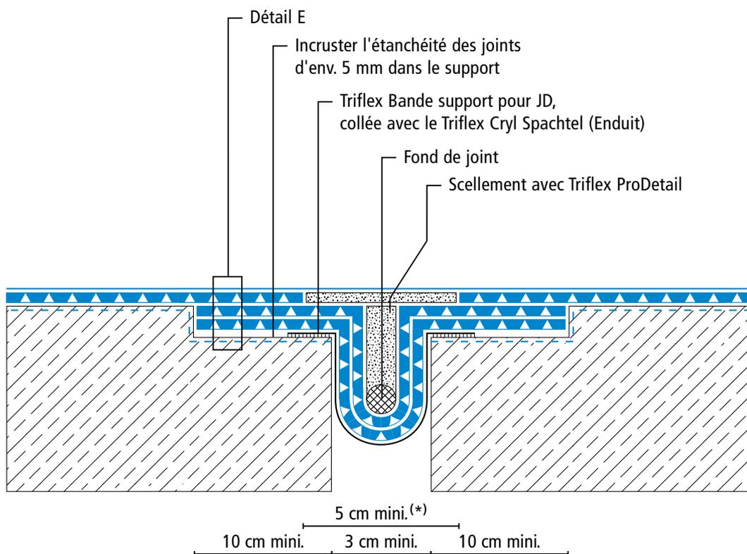
(\*) Emplacement pour système d'étanchéité de surface et couche utile (voir description du système)
