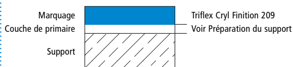
Structure du système, variante 2 – Détail B
